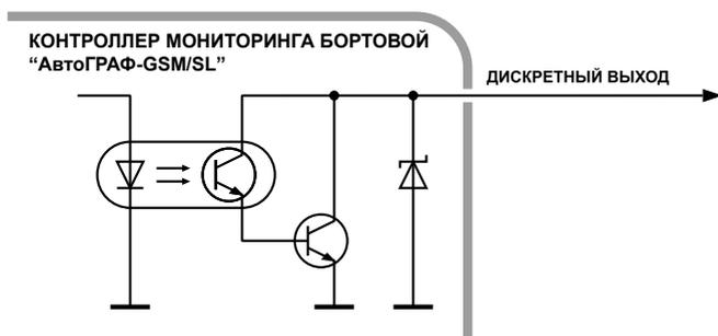
Рис. 16. Внутренняя схема выхода.
