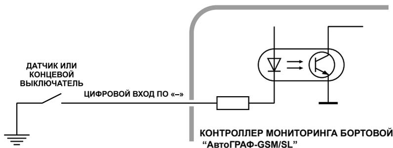
Рис.9. Подключение цифрового входа по «-».
