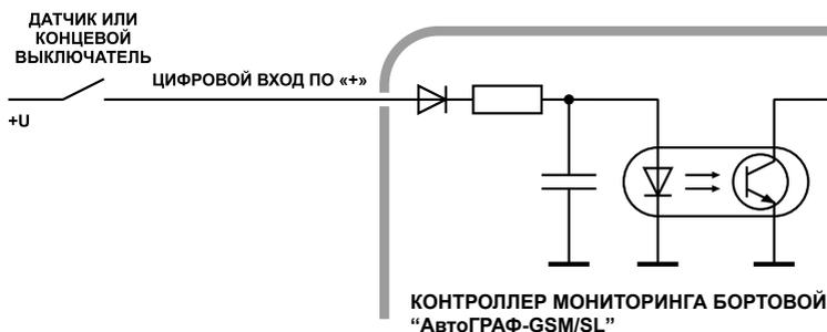
Рис.12. Внутренняя схема подключения цифрового входа по «+».
