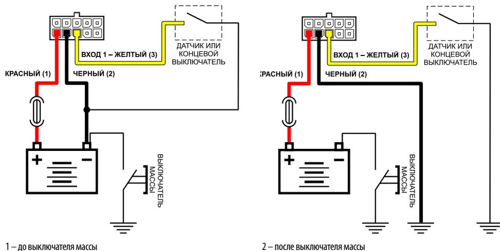
Рис.10. Подключение цифрового входа по «-».
