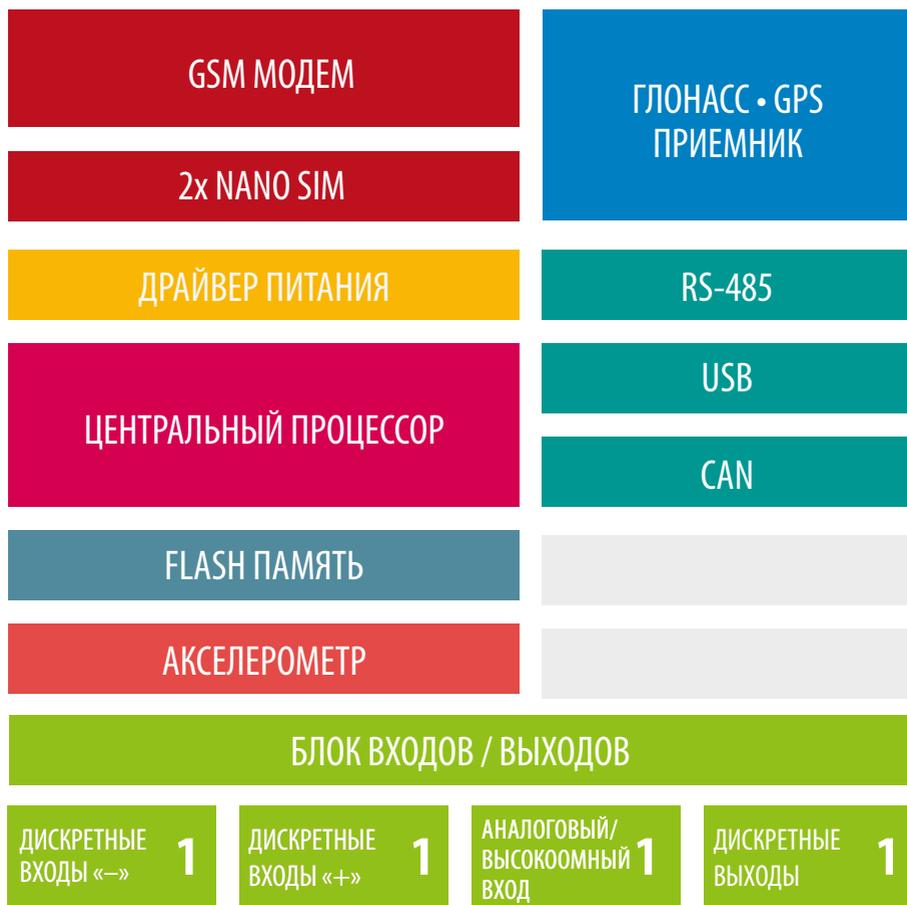
Рис.4. Функциональная схема.
