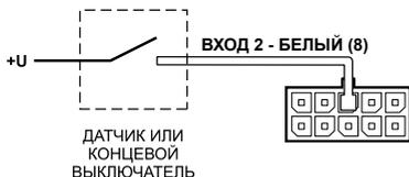
Рис.13. Внешняя схема подключения цифрового входа по «+».
