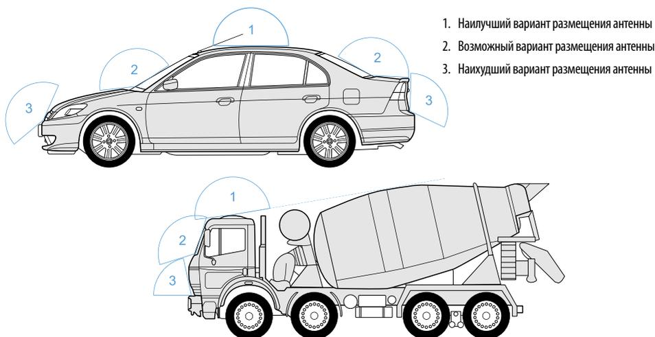
Рис.7. Установка GSM-антенны.
