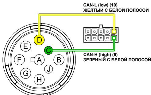
Рис.20. Подключение к шине CAN.
