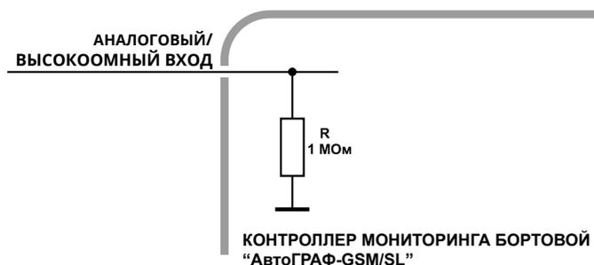
Рис.15. Подключения аналогового/высокоомного входа.
